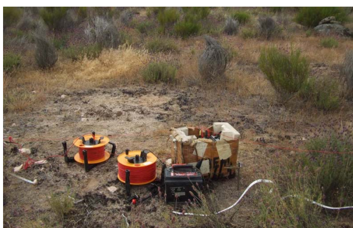
Equipo de adquisición y resultados de un sondeo eléctrico vertical
