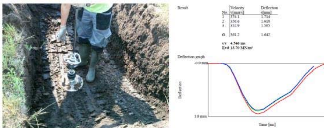
Fig. 6: Detalle de ensayos de placa de carga dinámica Zorn y resultado gráfico
