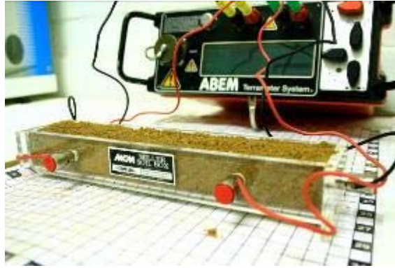
Fotografía 2: Detalle de medida de resistividad eléctrica en laboratorio mediante Soil-Box
