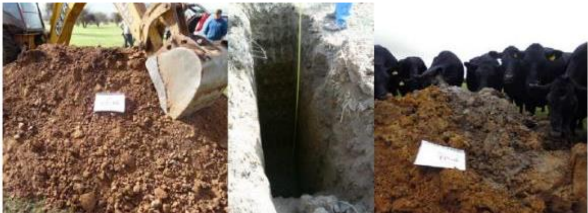
Fig. 3: Detalle de calicata mecánica para inspección y toma de muestras del terreno
