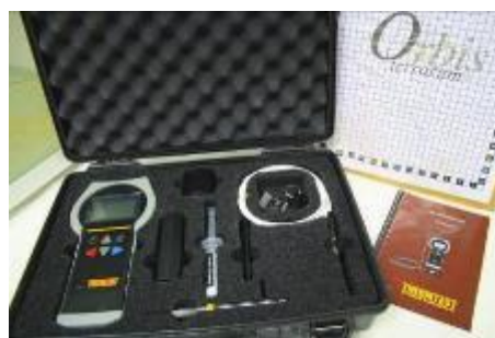
Fotografía 3: Detalle de equipo para medidas de resistividad térmica
