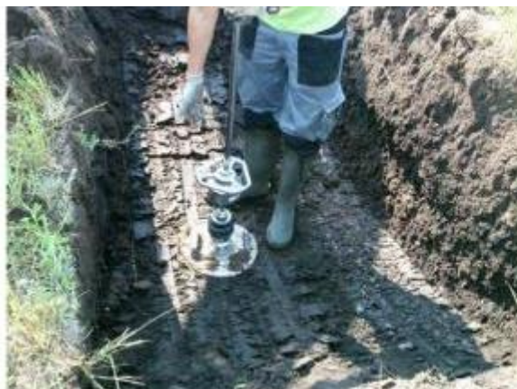
Fig. 7: Detalle de ensayos de placa de carga dinámica Zorn y resultado gráfico
